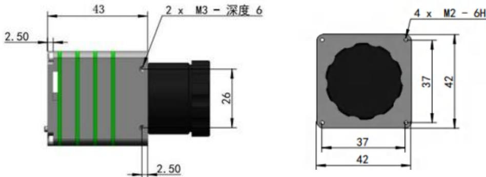
图 4.2 机械安装孔尺寸(单位: mm)
