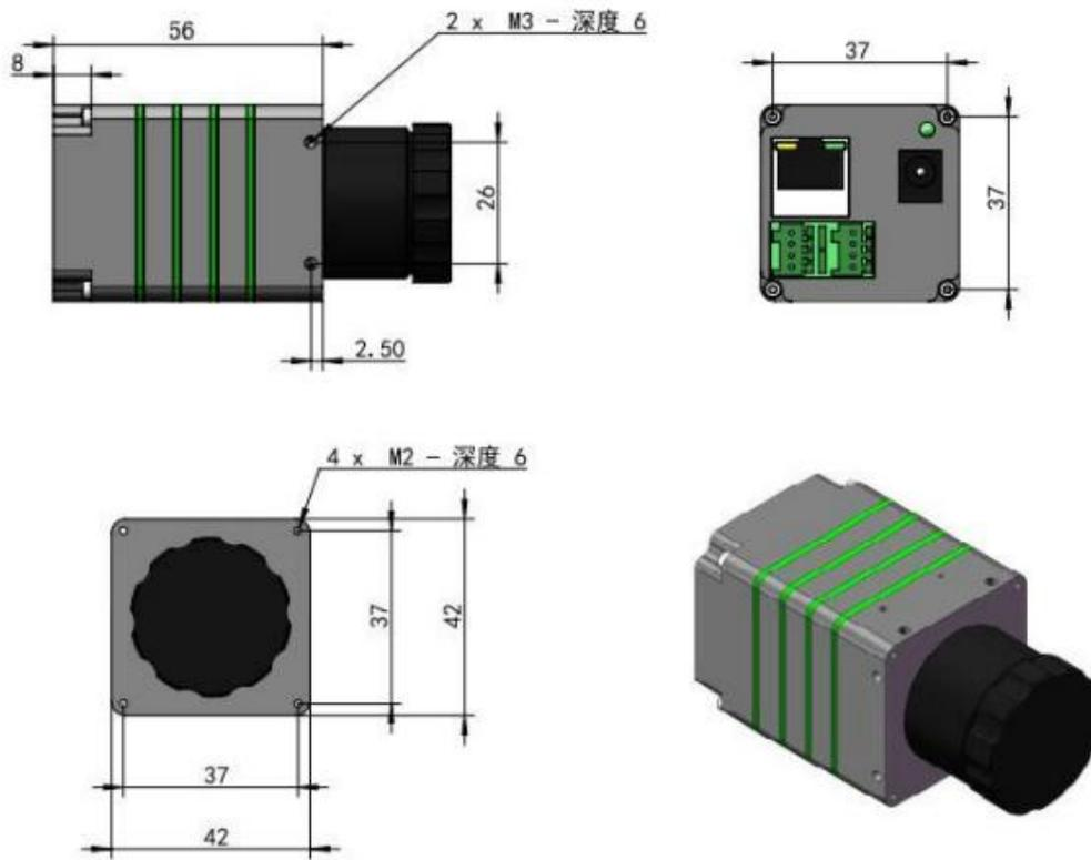
图 3.1 产品机械尺寸(单位: mm)
