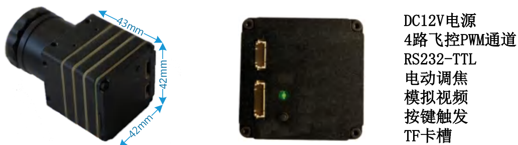
图 4.2 模拟型产品外观尺寸(单位: mm)
