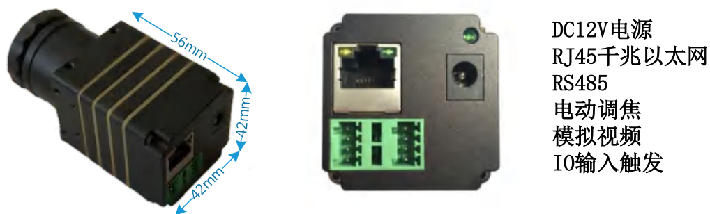
图 4.1 网络型产品外观尺寸(单位: mm)
