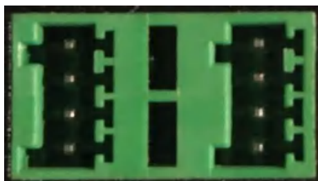
图 4.4 网络型接线端子示意图
