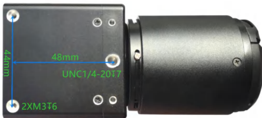
图 3.2 机械安装孔尺寸
