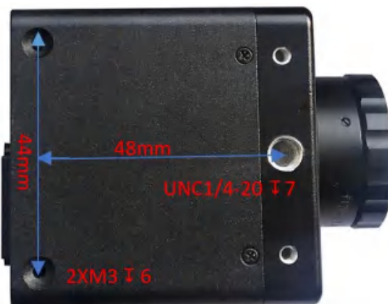
图 3.2 机械安装孔尺寸
